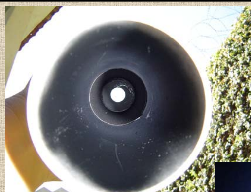
A mesma foto colocando-se a câmera dentro do tubo. Reparem na ausência de reflexão interna onde foi colado o papel camurça.
