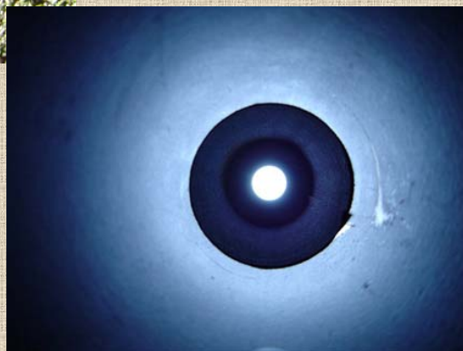
Foto feita com os 1 diafragma instalado. A parte dianteira ainda pintada de preto tendo ao fundo o papel camurça aplicado. Reparar no reflexo do tubo pintado.
